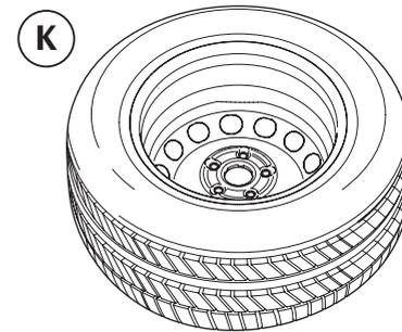
Rezervní kolo s pneumatikou (K) o rozměru 195/60 R16 není součástí sady - objednejte jej samostatně.
